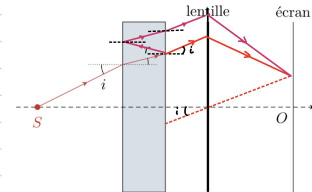
1) L'onde qui traverse directement la lame de verre interfère avec l'onde se réfléchissant deux fois dans la lame.
